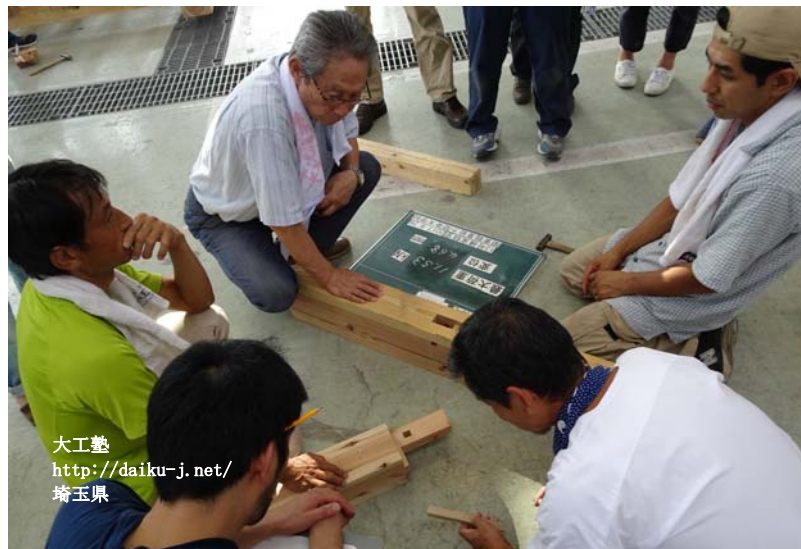
上と右：2017年8月の大工塾で行われた実大実験の様子。柱脚接合部の試験体7体、継手接合部の試験体8体、耐力壁（水平構面）の試験体3体、計18体の加力試験が2日間にわたり関東職業能力開発大学校で実施された。栃木県小山市
