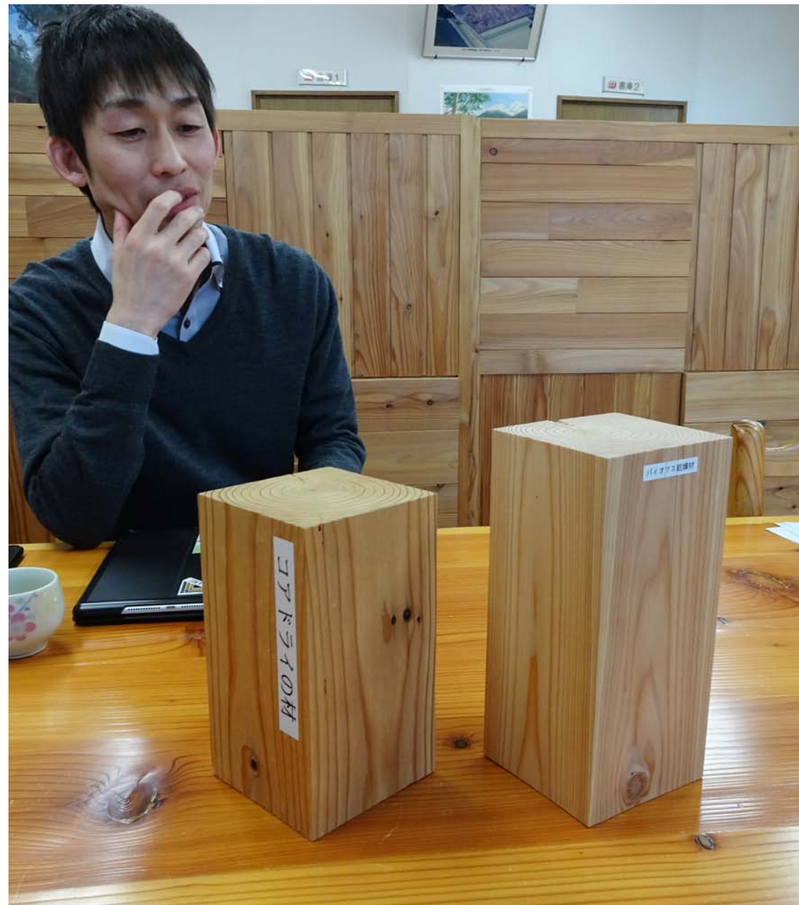
コアドライ材（高温乾燥材）とバイオ乾燥材（低温乾燥材）の試験体を並べて話をする瀬上さん。北海道のカラマツは本州に比べて若い。そのため、柱でも梁でも芯去り材ではなく、芯持ち材になる。そのことが、カラマツ材の扱いを一層難しくしている。（北海道中川郡幕別町）
