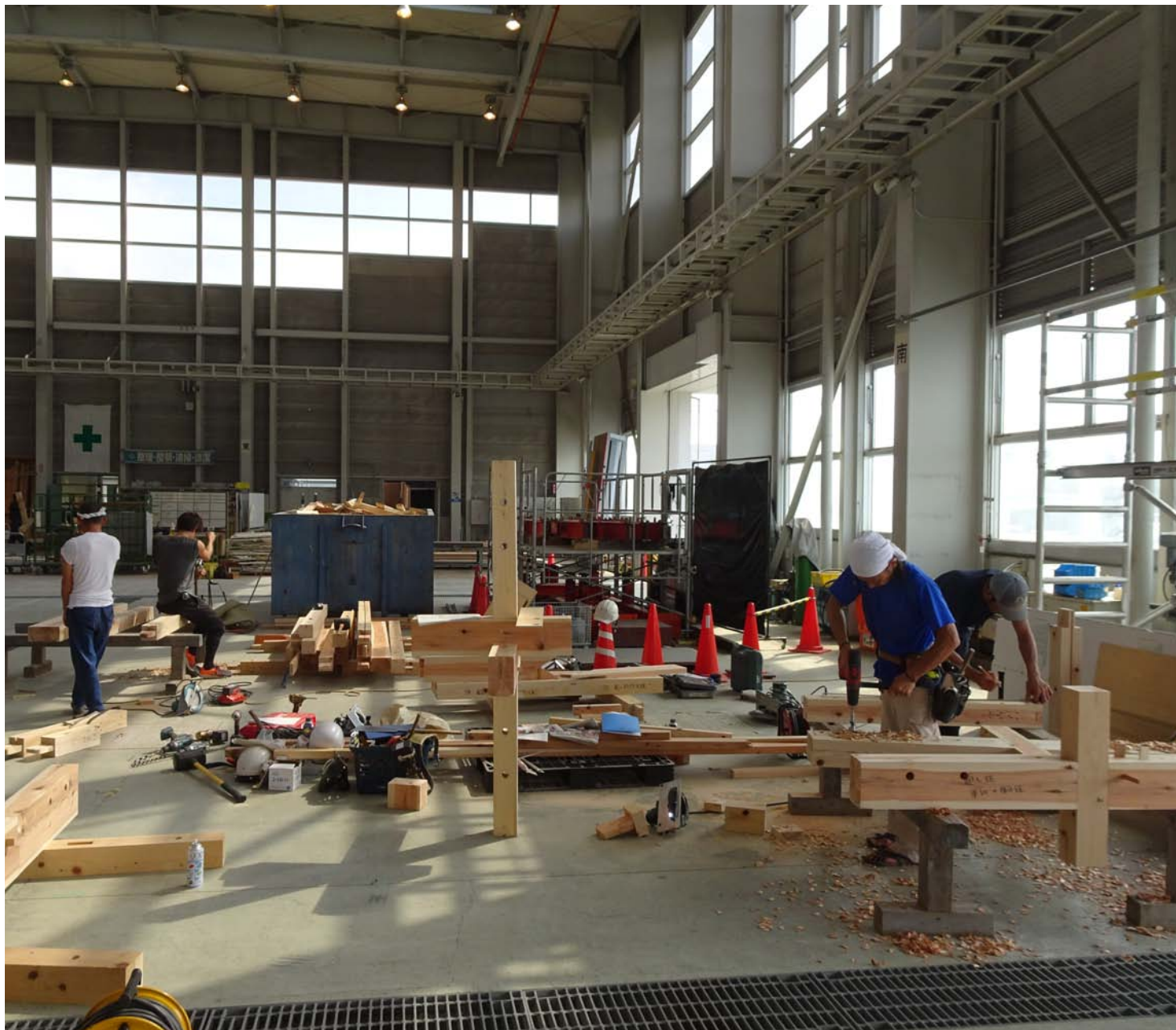
大工塾で行われる実大実験のため、試験体をドリルで加工する今枝一さん。 （栃木県小山市 関東職業能力開発大学校 応用実習場）
