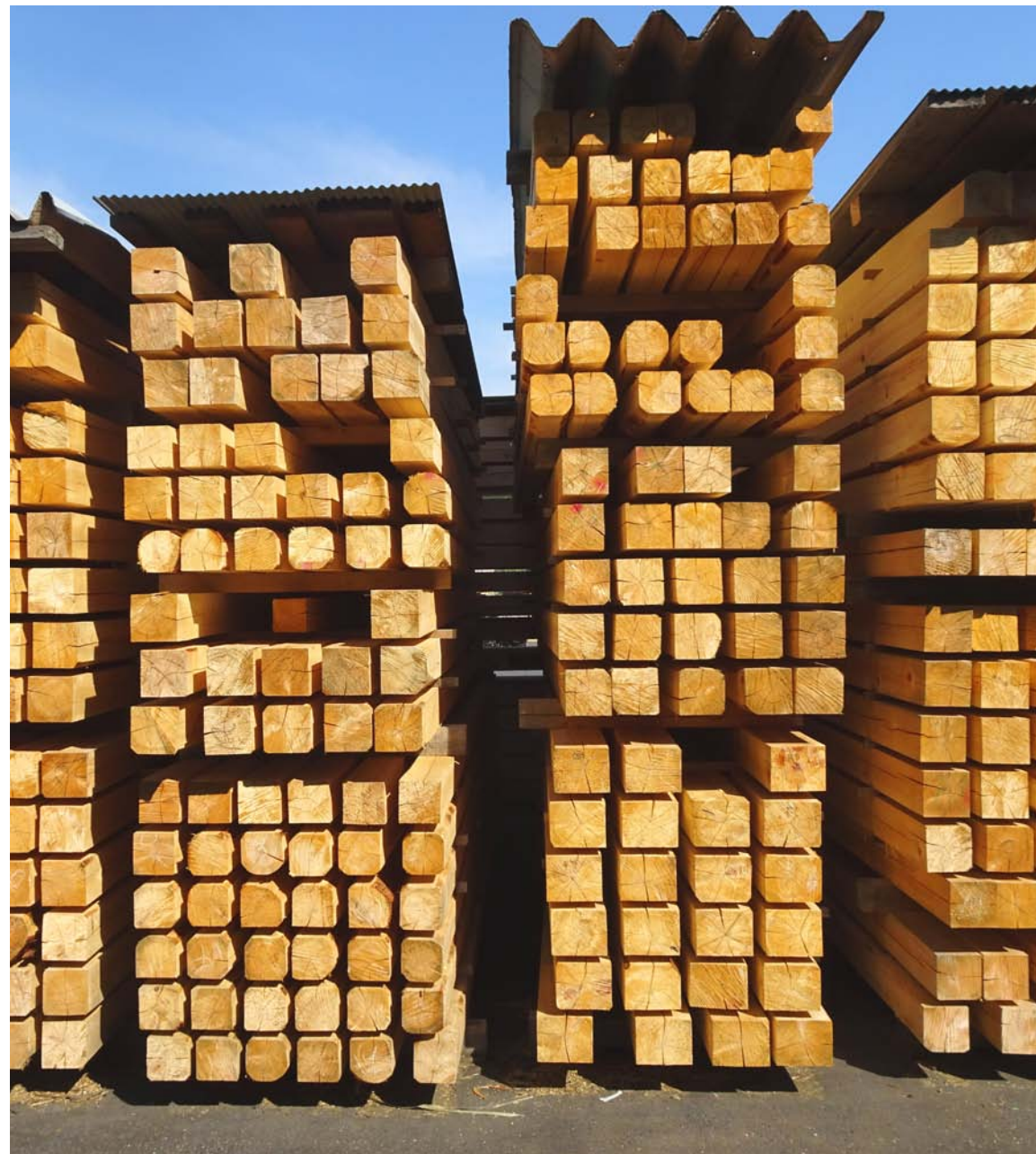
天然乾燥をするために積み重ねられた材木。割れ、反り、ねじれ、収縮。木の厄介さを受け入れながら使う天然乾燥材は、「木にしたがう」ことなしには扱えない。（埼玉県飯能市 大河原木材貯木場）
