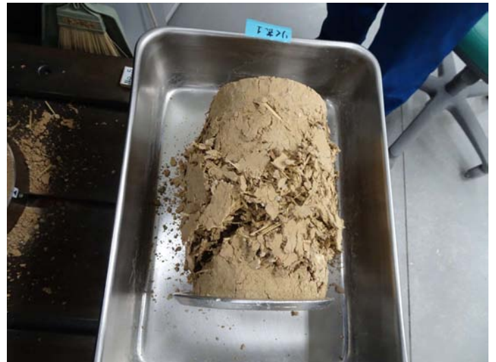
10破壊後試験体
