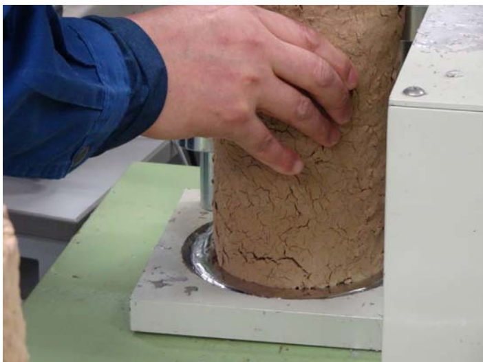
05キャップ施工
