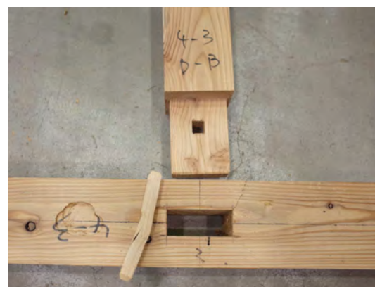
写真2 : 込栓の曲げせん断破壊
