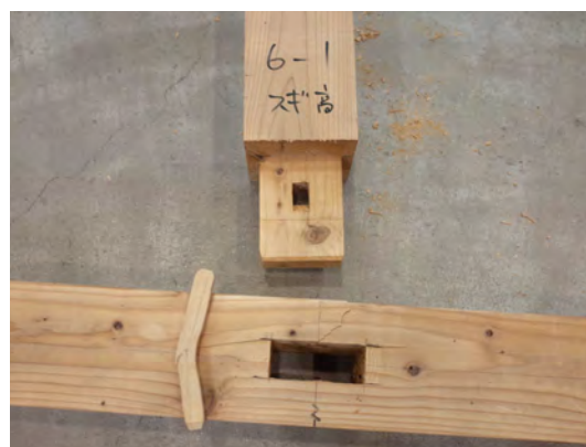
写真 2 : 込栓の曲げ破壊
