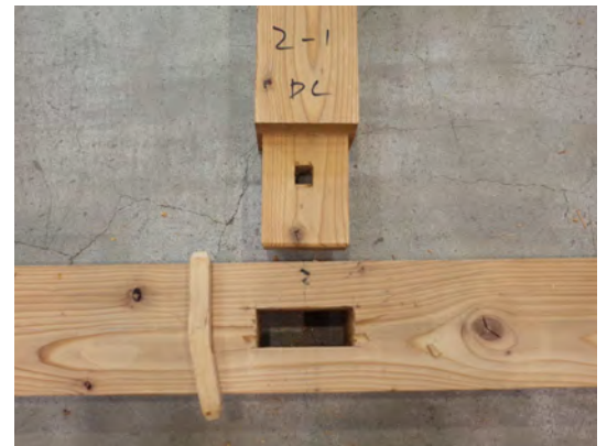
写真2：込栓の曲げ破壊
