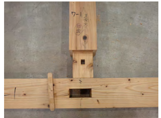
写真2：込栓の曲げせん断破壊
