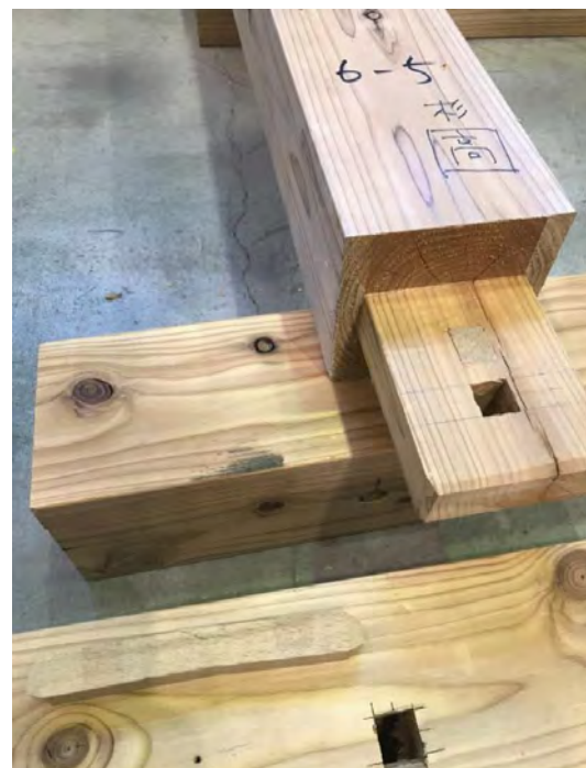
写真 1 : 込栓の曲げ破壊
