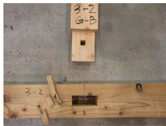
写真2：込栓の曲げせん断破壊
