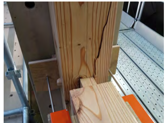
写真1 : 試験状況 (土台の割裂)
