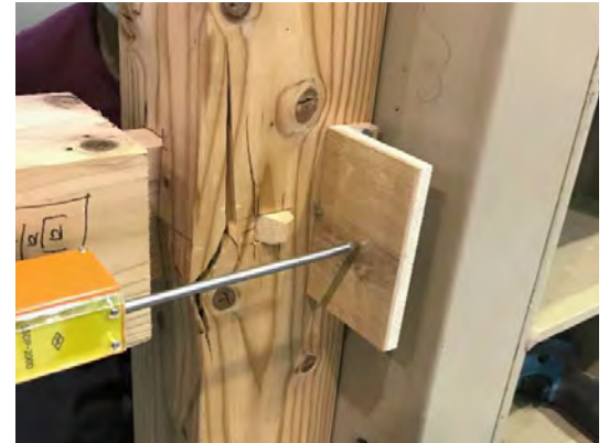
写真1；試験状況（土台の割裂）
