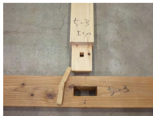
写真2 : 込栓の曲げせん断破壊
