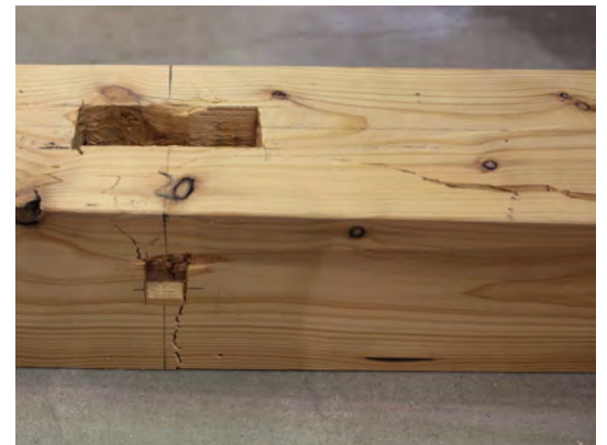
写真2：土台の破壊状況
