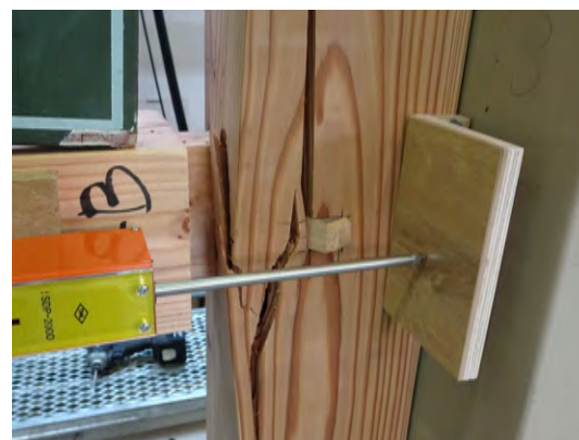
写真1：試験状況（土台の割裂）
