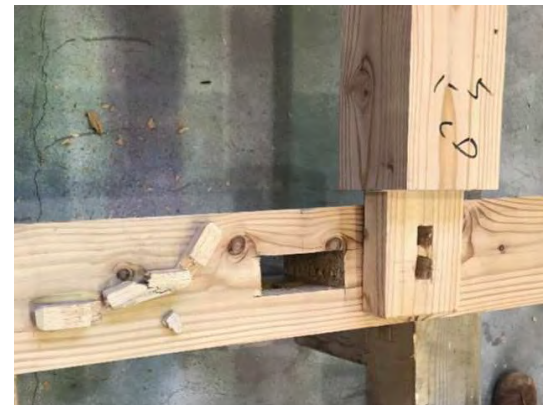
写真2 : 込栓の曲げせん断破壊
