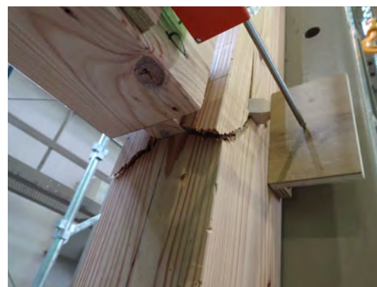
写真1 : 試験状況 (土台の割裂)
