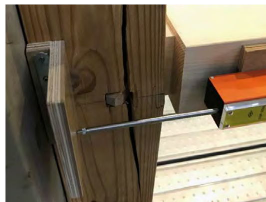
写真1：試験状況（土台の割裂）
