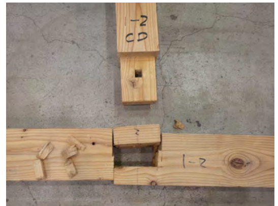
写真2 : 込栓の曲げせん断破壊
