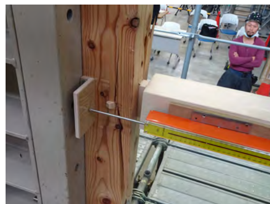
写真1：試験状況（土台の割裂）
