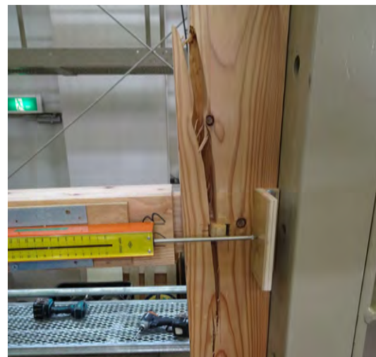
写真1：試験状況（土台の割裂）
