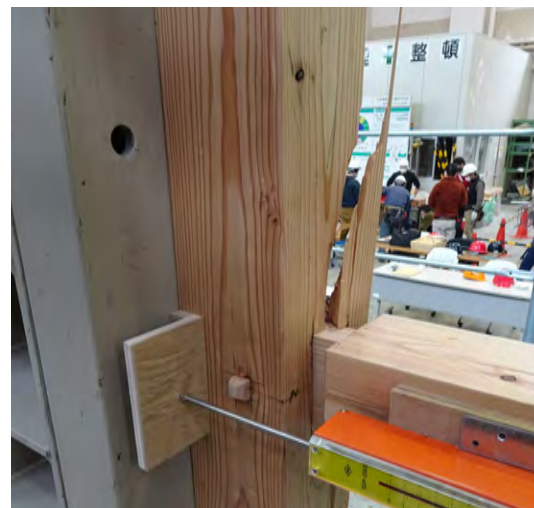
写真1：試験状況（土台の割裂）
