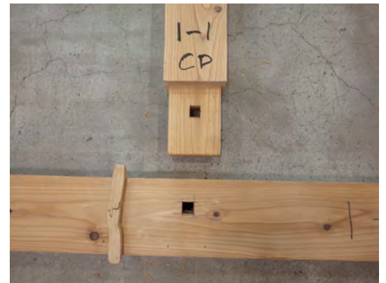
写真 2：込栓の曲げせん断破壊
