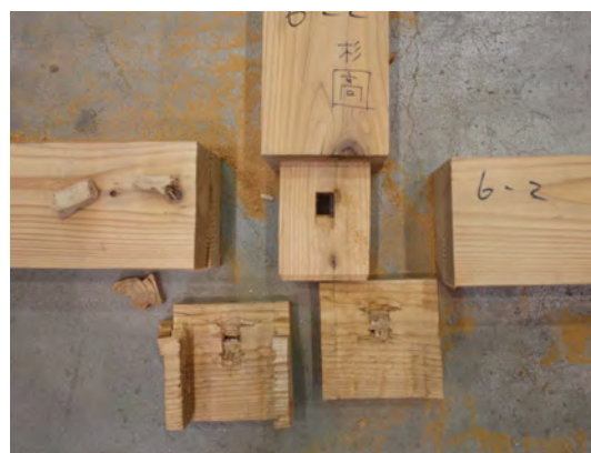
写真2 : 込栓の曲げせん断破壊
