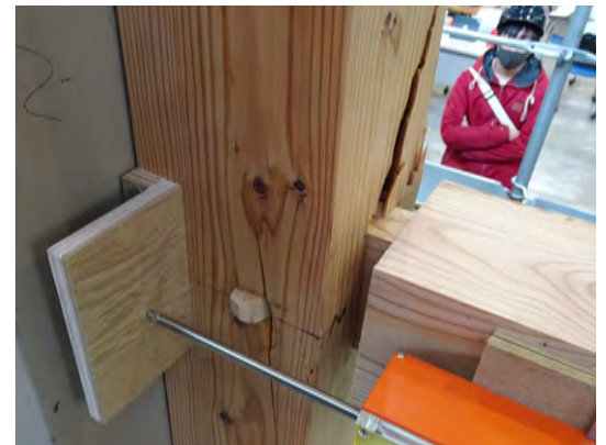
写真1 : 試験状況 (土台の割裂)
