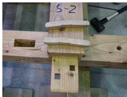
写真2 : 込栓の曲げ破壊、土台の割裂
