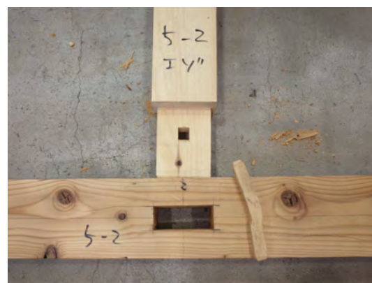
写真2：込栓の曲げせん断破壊
