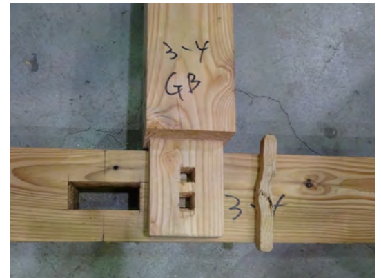
写真2 : 込栓の曲げせん断破壊
