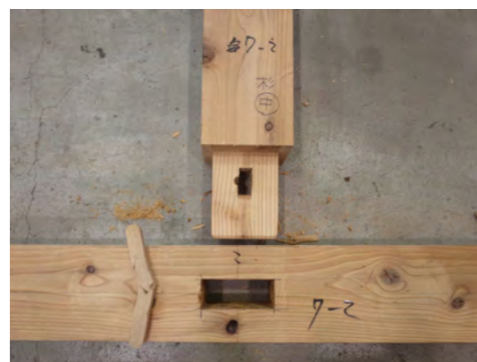
写真2 : 込栓の曲げせん断破壊
