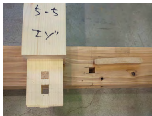
写真2 : ホゾのせん断破壊
