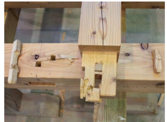
写真2 : 込栓の曲げせん断破壊、土台の割裂、ホゾのせん断破壊
