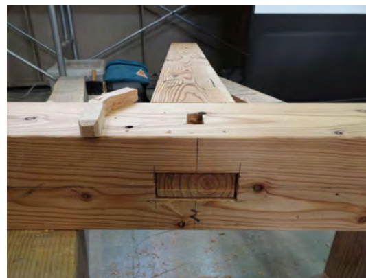
写真 2 : 込栓の曲げ破壊
