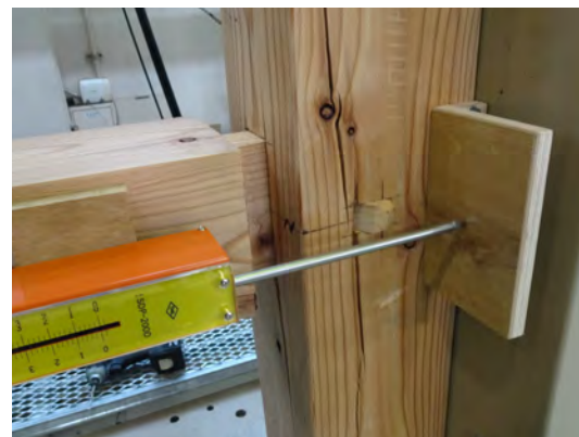
写真1：試験状況（土台の割裂）
