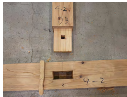
写真2：込栓の曲げせん断破壊
