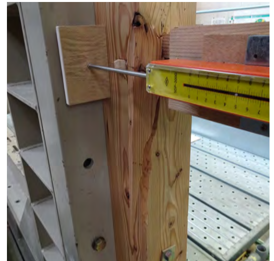
写真1：試験状況（土台の割裂）
