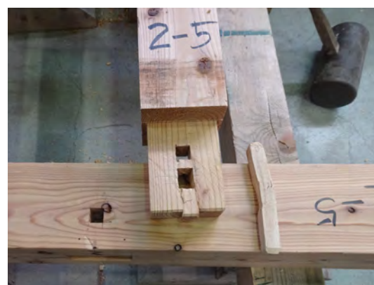
写真2 : ホゾのせん断破壊 込栓の曲げせん断破壊
