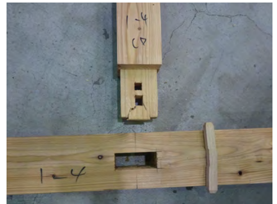
写真2 : ホゾのせん断破壊 込栓の曲げせん断破壊
