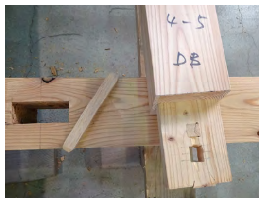
写真2 : ホゾのせん断破壊
