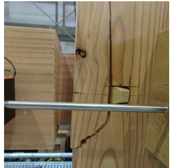
写真1 : 試験状況 (土台の割裂)
