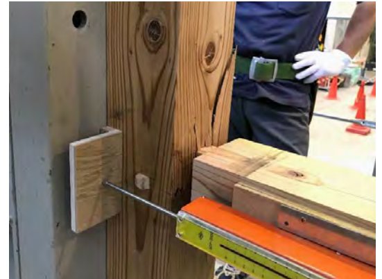
写真1：試験状況（土台の割裂）
