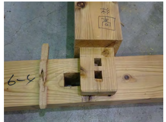
写真2：込栓の曲げせん断破壊
