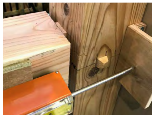
写真1：試験状況（土台の割裂）
