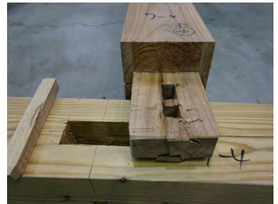
写真2 : ホゾのせん断破壊
