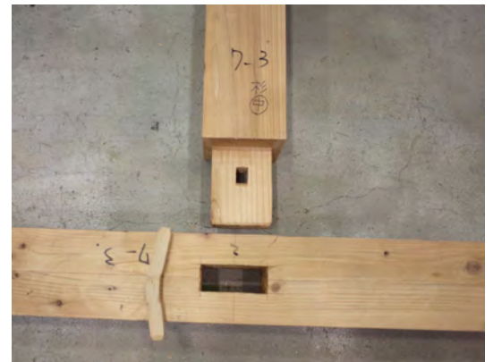
写真2 : 込栓の曲げせん断破壊
