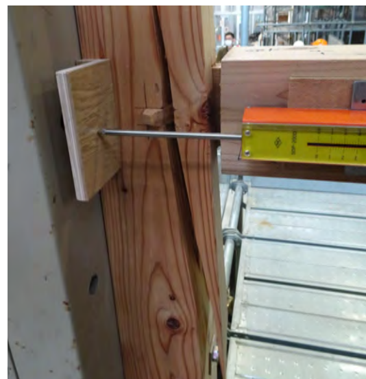
写真1 : 試験状況 (土台の割裂)
