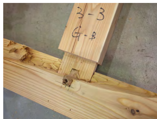
写真2：土台の割裂、込栓の曲げせん断破壊
