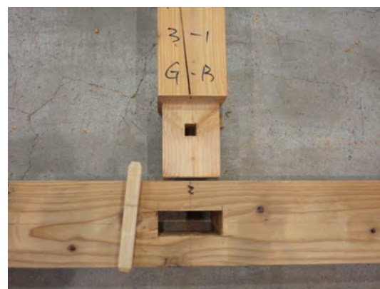
写真2：込栓の曲げせん断破壊
