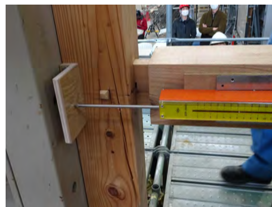
写真1 : 試験状況 (土台の割裂)
