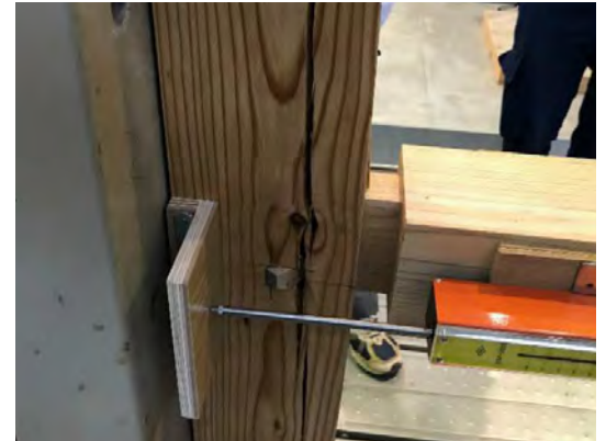
写真1 : 試験状況 (土台の割裂)
